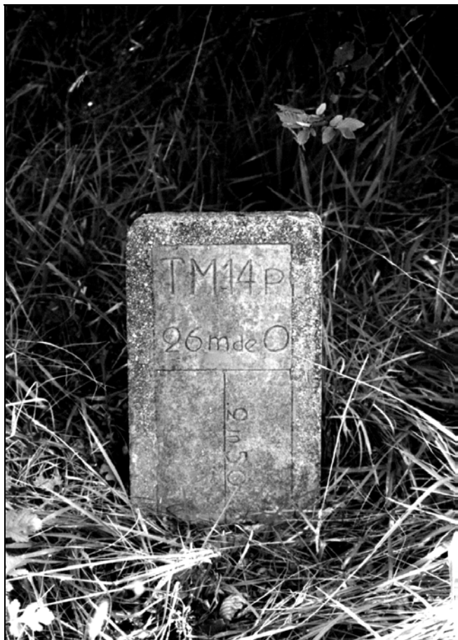
Figure 16 : Ouvrage de l'Agaisen , borne repère
